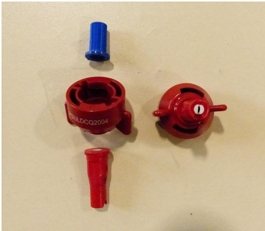
Flachstrahldüse John Deere PSULDCQ2004 (Keramik, kunststoffummantelt, rot)
